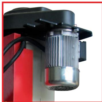
Due motori speciali autofrenanti ad alto rendimento per garantire potenza e durata nel tempo, dotati di sonda termica di protezione
